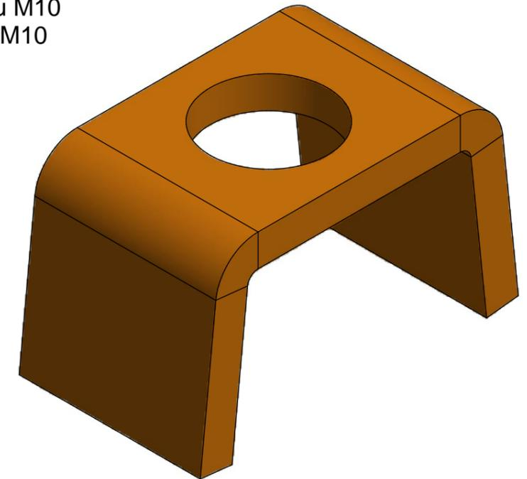
I3 : Tôle d'acier inoxydable suivant NF EN 10088-2 (316L).
